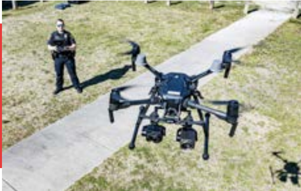
Görsel 4. Bir Polis Teknoloji Görevlisi, yangın önleme ve diğer kullanımlar için termal görüntüleme özelliklerine sahip bir DJI Matrice drone'u gösteriyor. (Kamu malı - Lisans: CC0)
