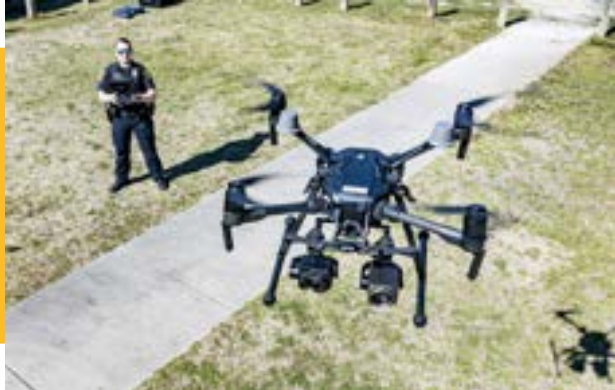
Figura 4. Un oficial de policía muestra un dron DJI Matrice con capacidades de imágenes térmicas para la prevención de incendios y otros usos. (Dominio público - Licencia: CC0)
