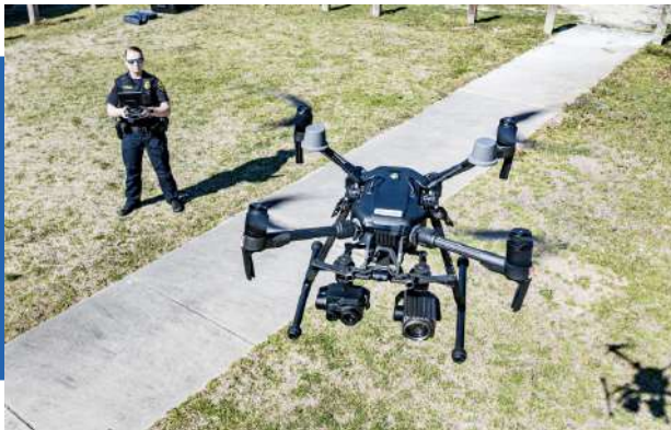
Зображення 4. Поліцейський технолог демонструє дрон DJI Matrice з тепловізійними можливостями для запобігання пожежам та інших цілей. (Суспільне надбання – Ліцензія: CC0)
